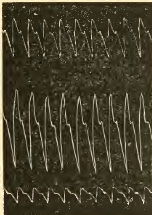
Fig. 1. — Pouls artificiel pris avec trois tambours différents : en haut, tracé donné par un grand tambour, à membrane très molle; au milieu, tracé donné par un petit tambour à membrane très molle; en bas, ligne inférieure, tracé pris avec un grand tambour à membrane dure.
