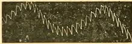
Fig. 2. — Pouls artificiel combiné à une oscillation artificielle: ces deux mouvements, produits par deux cames différentes, associées à deux tambours différents, arrivent à un tambour unique, qui les combine et les inscrit sur le cylindre. On voit qu'au sommet supérieur de l'ondulation, quand la membrane est tendue, la pulsation est un peu plus petite qu'au sommet inférieur.
