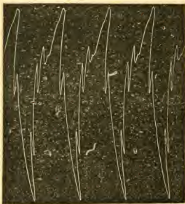
Fig. 137. — Tracé rajû le du même mouvement, déformé par des projections de plume.
