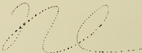
Fig. 100. — Lettres tracées avec la plume électrique ; entre deux points successifs il y a 0,006 de seconde.
