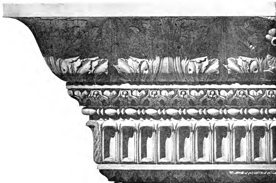
311. — Corniche du temple de la Concorde à Rome. (Restaur. de Daumet.) (D'après d'Espouy, op. cit. )
