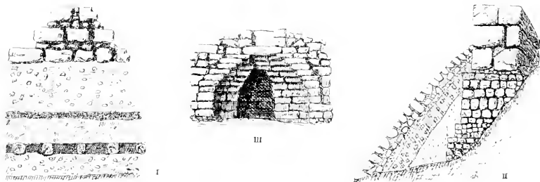
102. — Procédés de la construction cananéenne.
