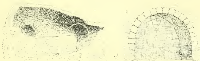
257. — Types des voûtes réalisées à Idikutshari I. Ruines d'une coupole sur trompes d'angle. — II. Berceau.
