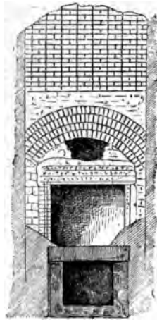
FIG. 136. — MASTABA DE VI e DYNASTIE, AVEC VOUTE DE DÉCHARGE
