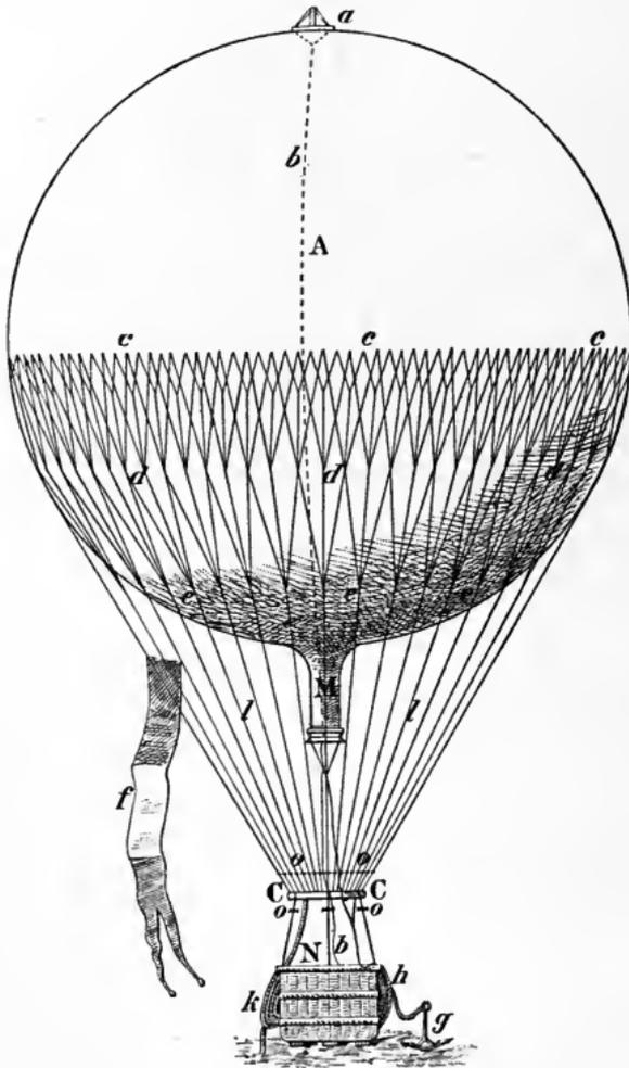
Fig. 11. — Ensemble du grément d'un aérostat.
