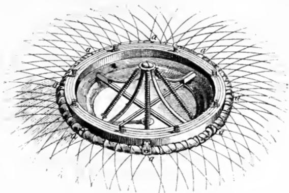
Fig. 23. — Couronne d'un ballon et soupape d'Yon.
