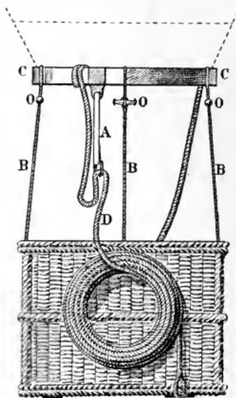
Fig. 25. — Corde d'ancre avec sangle de caoutchouc de Giffard.
