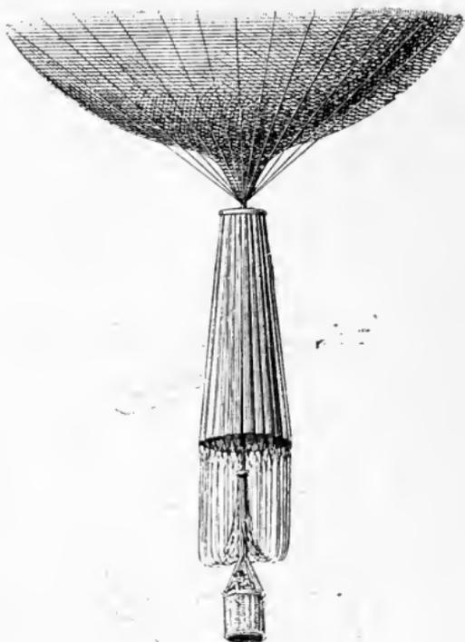
Fig. 77. — Parachute de Garnerin (fermé).
