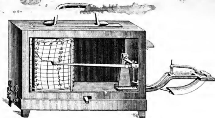
Fig. 37. — Thermomètre enregistreur.
