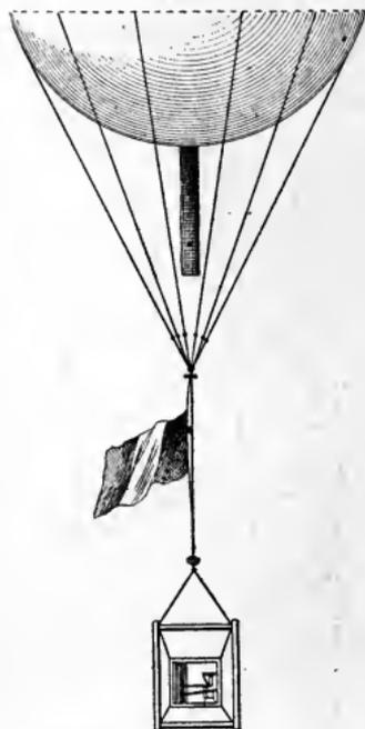
Fig. 18. — Filet et panier d'un ballon-sonde.
