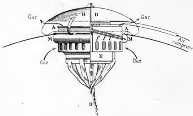
Fig. 108. — Soupape de Renard (ouverte).
