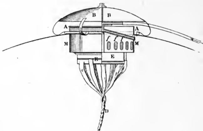
Fig. 107. — Soupape de Renard (fermée).
