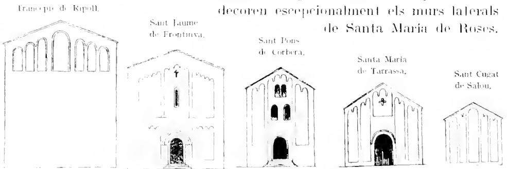
Fig. 440. — Decoració de fatxades. Quadre comparatiu. Escala 1 per 100.
