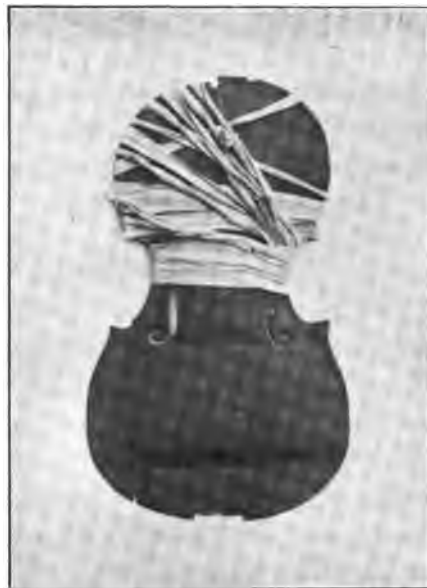
Fig. 94. — PROCÉDÉ POUR COLLER LES BORDS ET LES FILETS APRÈS LE RECOUPAGE.
