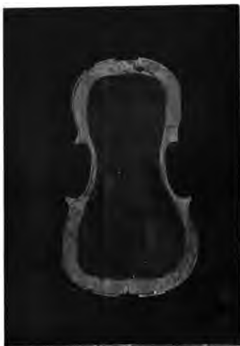
Fig. 83. — TABLE PRÉPARÉE POUR RECEVOIR DES DEMI-BORDS.
