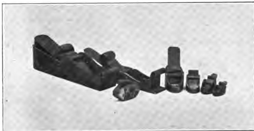
Fig. 25. — UNE FAMILLE DE RABOTS EN FER SPÉCIAUX A LA LUTHERIE.
