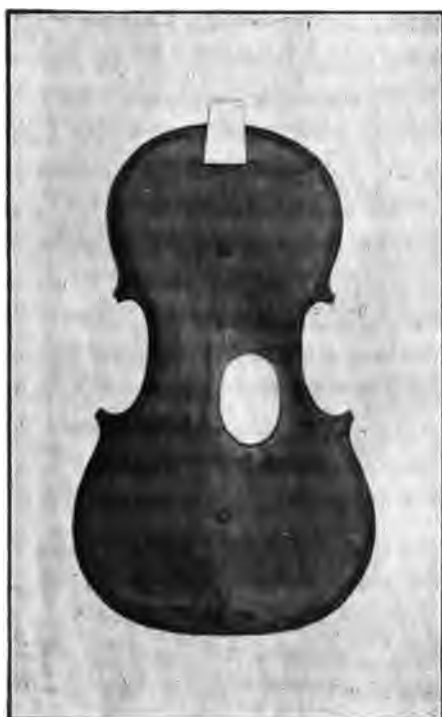
Fig. 87. — PIÈCE A DEMI-BOIS ET A QUEUE POUR RECONSTITUER LE TALON ET PIÈCE A BOIS FORCÉ A L'ÂME.
