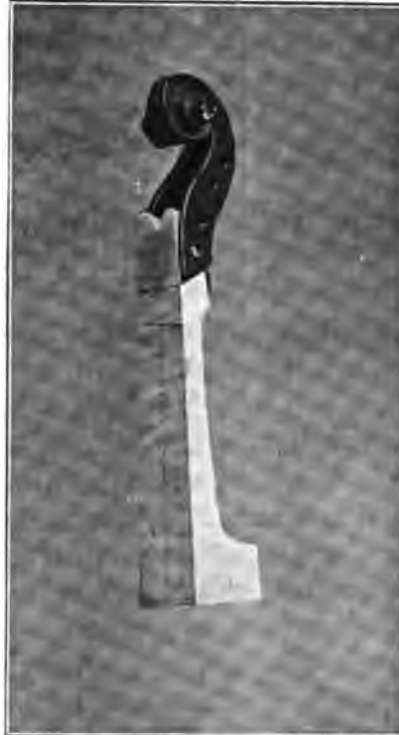
Fig. 90. — ENTURE COLLÉE A SA PLACE.
