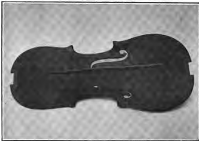
Fig. 62. — TABLE TERMINÉE ET POURVUE DE SA BARRE.
