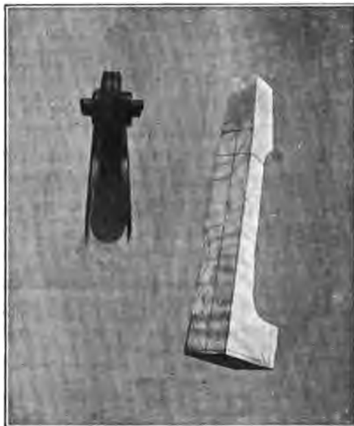
Fig. 89. — ENTURE DE MANCHE DISJOINTE.
