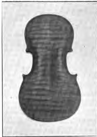
Fig. 58. — EBAUCHE D'UNE TABLE (second état). Les bords sont d'épaisseur et l'entaille des filets est terminée.
