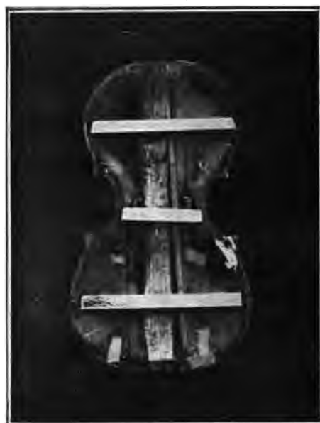
Fig. 92. — SOUTIENS DE LA TABLE AVANT LE RECOUPAGE.
