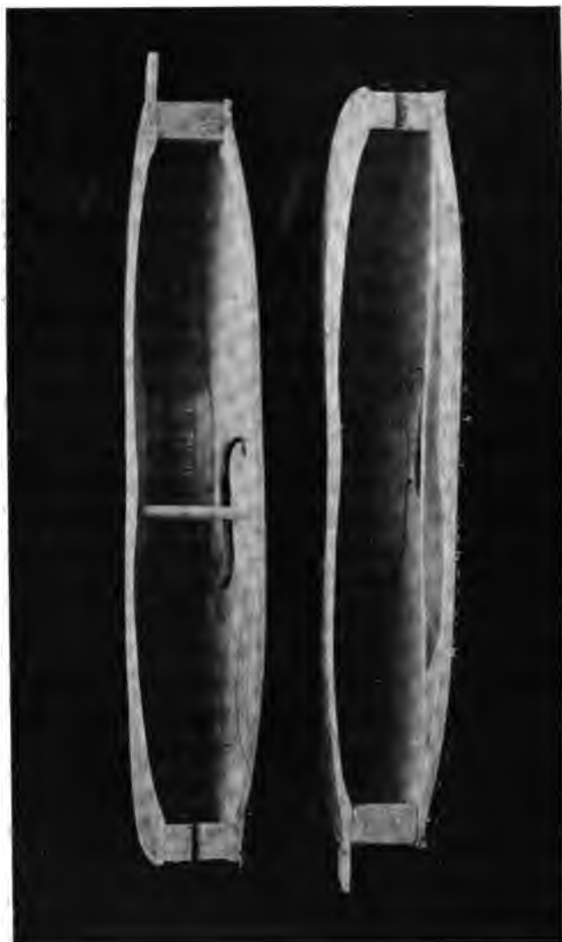
Fig. 60. — COUPE LONGITUDINALE DU CORPS D'UN VIOLON.
