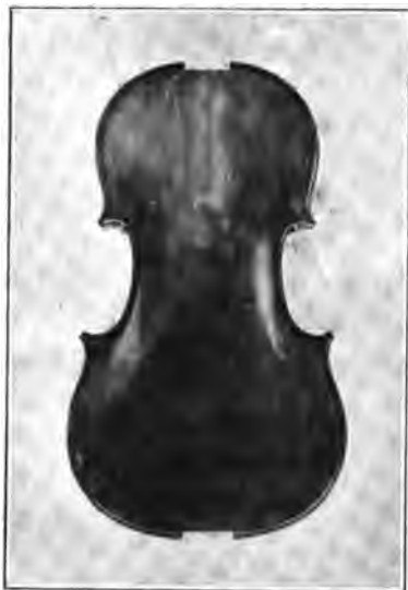
Fig. 59. — TABLE AVEC VOUTE, FILETS ET GORGE TERMINÉS.
