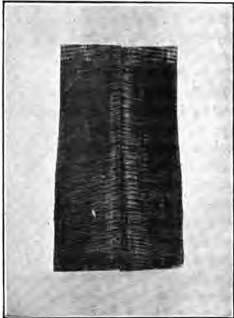
Fig. 42. — FOND DE VIOLON DE DEUX PIÈCES APRÈS L'ASSEMBLAGE.
