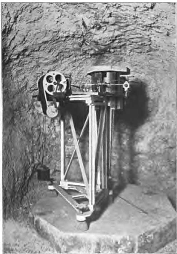
Fig. 8. — Pendule astatique de Wiechert de 200 kilogrammes.
