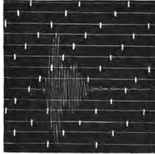
Fig. 7. — Sismogramme obtenu à Santiago du Chili, le 8 juin 1909, avec un pendule Bosch-Omori non amorti.
