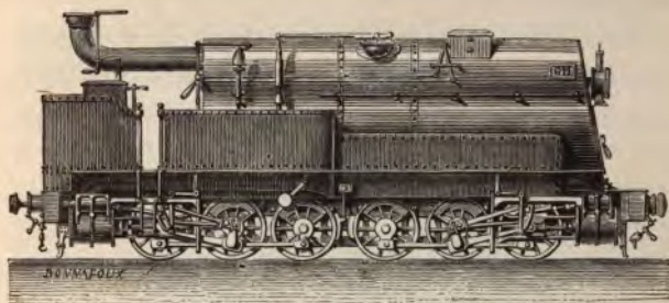
Fig. 95. --- Machine à marchandises de la ligne du Nord, à douze roues couplées et à quatre cylindres.
