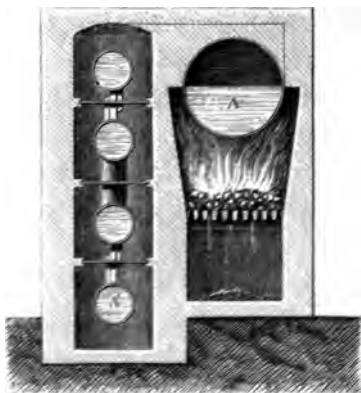
Fig. 57. — Chaudière Farcof, à bouilleurs latéraux
