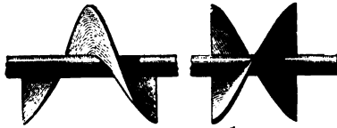
Fig. 71. — Premières hélices de Smith. Hélice simple d'un pas entier; hélice double d'un demi-pas.
