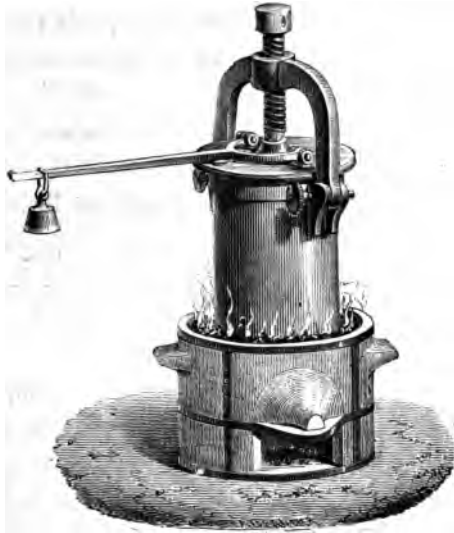
Fig. 13. — Marmite de l'apin ou Nouveau Digesteur (1681).
