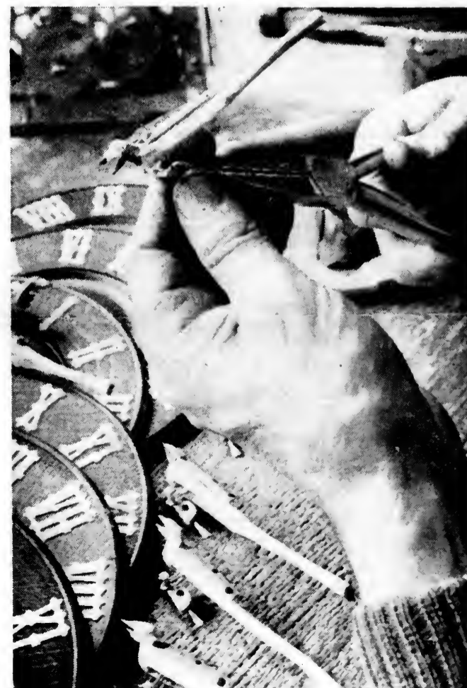
Hier werden die Kuckuckspfeifen und hölzernen Zifferblätter zum Einsetzen fertig gemacht. Aufnahmen: Fritz Carl, Berlin (6).
