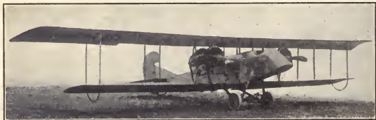
FIG. 11.—U. S. army battle plane. Two 100 h.p. motors; speed 85 mi. per hr.
