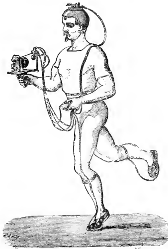
Fig. 87. — Coureur muni des appareils explorateurs et enregistreurs des diverses allures.
