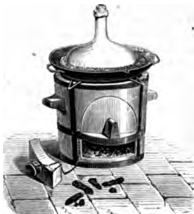
Fig. 673. — Préparation du bioxyde de mercure.
