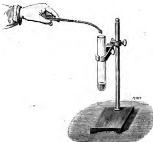
Fig. 425. — Inflammation du potassium dans le brome.
