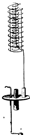
Fig. 717. — Spirale de platine placée au-dessus de la mèche de la lampe de sûreté.
