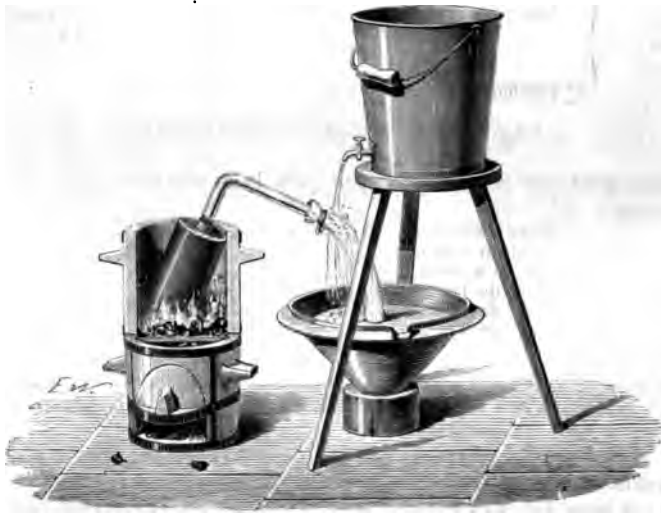
Fig. 672. — Purification du mercure par distillation.
