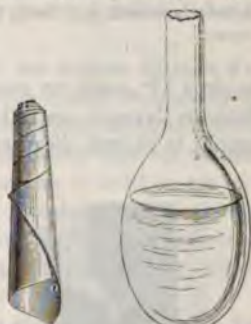
Fig. 703. — Or roulé en cornet pour les essais. Fig. 704. — Matras d'essayeur.
