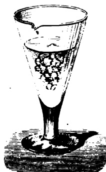
Fig. 691. — Précipité caillé formé par les composés du chlore dans l'azotate d'argent.
