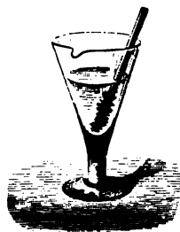
Fig. 656. — Précipitation du plomb de sa dissolution par les lames métalliques.
