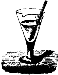
Fig. 626. — Précipitation de l'étain de ses dissolutions par une lame de zinc.
