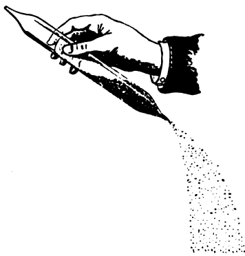
Fig. 360. — Inflammation spontanée du fer réduit par l'hydrogène.
