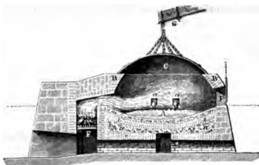
Fig. 679. — Section verticale du fourneau de coupelle, employé à Clausthal dans le Hartz.
