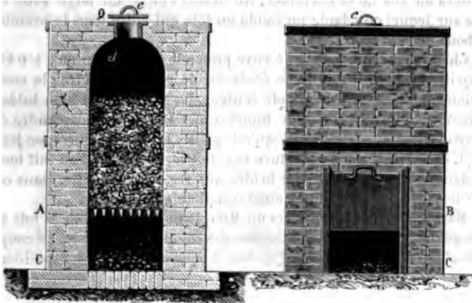
Fig. 567. — Four coulant pour le grillage des pyrites.
