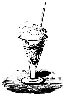
Fig. 351. — Réaction de l'étain sur l'acide azotique.
