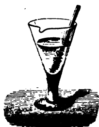
Fig. 381. — Précipitation du cuivre par une lame de fer.
