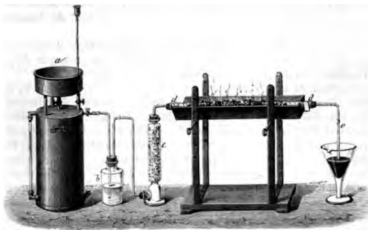
Fig. 499. — Préparation du bioxyde de baryum.
