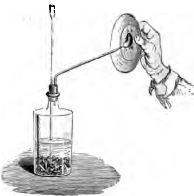
Fig. 571. — Essai de l'acide sulfurique arsenical.
