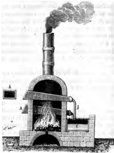
Fig. 566. — Calcination des pyrites jaunes pour l'extraction du soufre.
