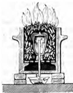
Fig. 530. — Appareil pour la distillation du zinc dans les laboratoires.
