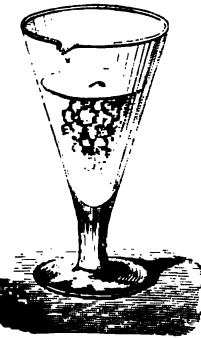
Fig. 384. — Précipités caillebottés formés par l'acide chlorhydrique dans les sels d'argent, de mercure et de plomb.
