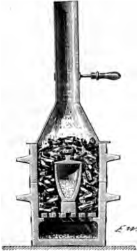
Fig. 497. — Préparation du sulfure de baryum dans les laboratoires.
