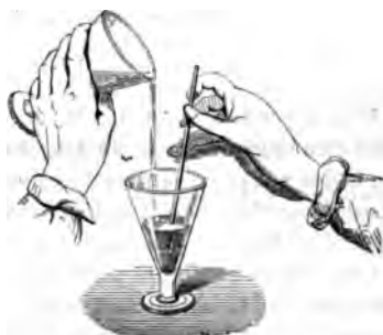
Fig. 400. — Neutralisation de l'acide sulfurique par la potasse.
