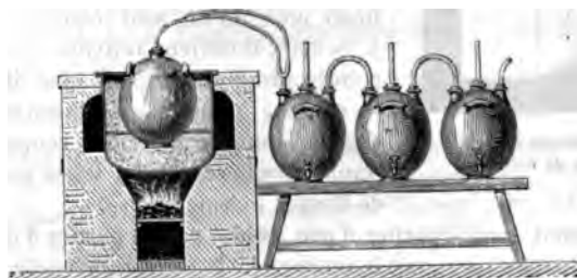
Fig. 642. — Production du sulfate de cuivre et de l'acide sulfurique.
