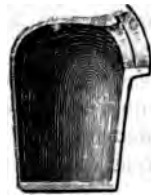
Fig. 600. — Creuset de verrerie pour les fours à la houille.
