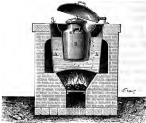
Fig. 493. — Appareil pour la préparation de la pâte inflammable des allumettes chimiques.
