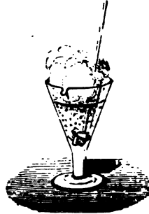
Fig. 627. — Réaction de l'étain sur l'acide azotique.
