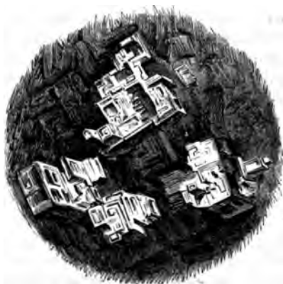
Fig. 343. — Cristallisation du bismuth par fusion et refroidissement.
