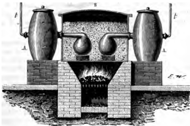
Fig 423. — Sublimation de l'iode dans l'appareil des fabriques.
