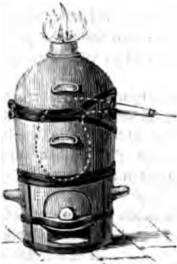
Fig. 498. — Préparation de la baryte caustique par la calcination de l'azotate.
