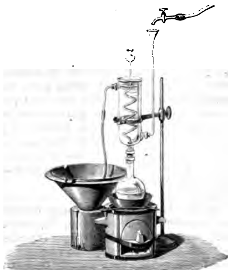
Fig. 438. — Concentration de la solution alcoolique de potasse hors du contact de l'air.
