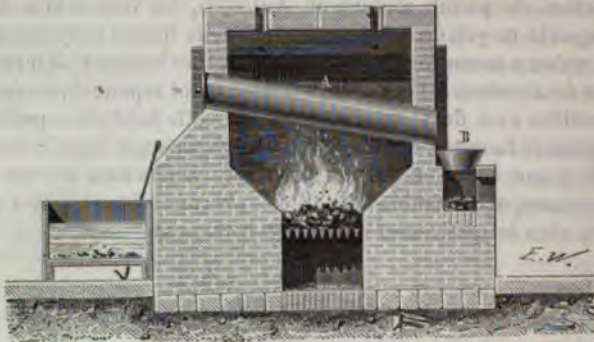
Fig. 665. — Coupe transversale de l'appareil de Schneeberg pour l'extraction du bismuth.
