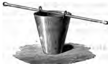
Fig. 405. — Cristallisoirs en tôle pour isoler le chlorure de potassium.
