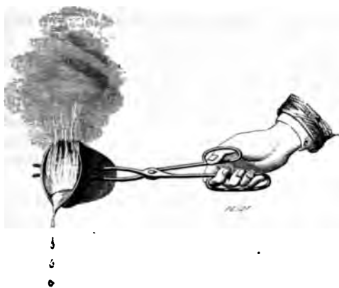
Fig. 531. — Combustion et oxydation du zinc dans l'air au rouge blanc.
