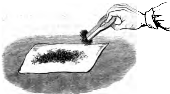
Fig. 345. — Action du barreau aimanté sur le fer.
