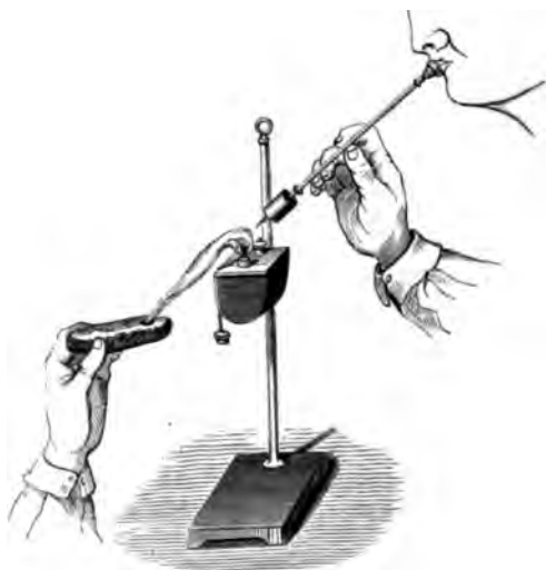
Fig. 454. — Essai d'un minéral par le verre de borax au chalumeau.
