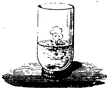
Fig. 337. — Action du potassium sur l'eau au contact de l'air.
