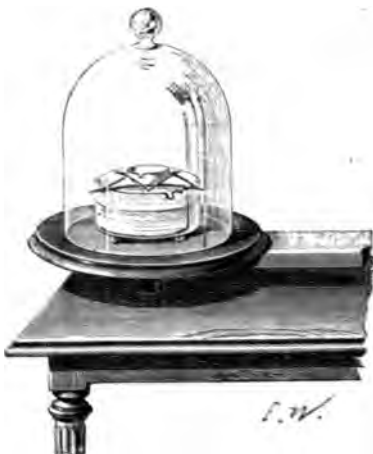
Fig. 517. — Cristallisation dans le vide du manganate de potasse.
