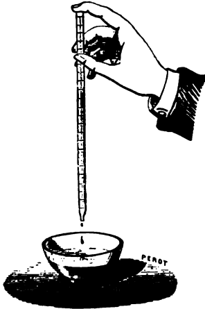
Fig. 422. — Sulphydromètre de Dupasquier.
