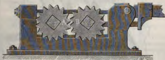
Fig. 541. — Cylindres concasseurs pour les minerais en roche.
