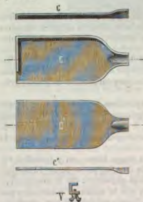
Fig. 444. — Récipient modifié pour l'extraction du sodium.
