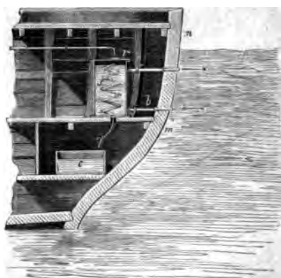
Fig 465. — Appareil Rocher pour la distillation de l'eau de mer.
