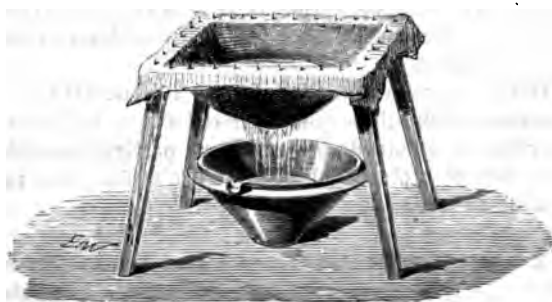
Fig. 582. — Toile ou carrelet pour le filtrage et l'égouttage des précipités.
