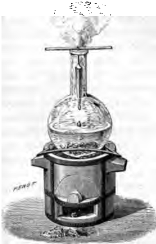
Fig. 668. — Fusion des alliages du bismuth dans la vapeur d'eau bouillante.
