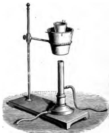
Fig. 724. — Calcination au moyen de la lampe à gaz.
