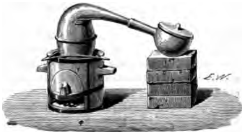
Fig. 621. — Appareil complet pour l'attaque des silicates.
