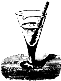
Fig. 690. — Précipitation de l'argent de ses dissolutions par les lames métalliques.
