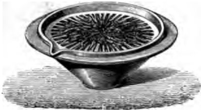
Fig. 478. — Cristallisation de l'azotate de potasse en petites aiguilles.
