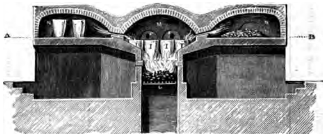
Fig. 599. — Four de verrerie M avec creusets I, I, I, et arches N, N servant à la fritte et à la dessiccation des creusets neufs.
