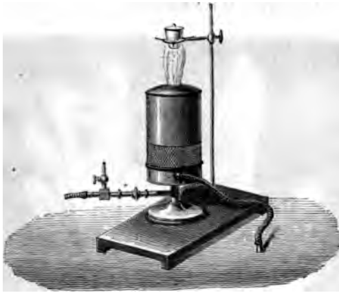
Fig. 595. — Attaque d'un silicate par la potasse ou la soude.
