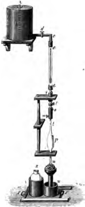
Fig. 693. — Appareil pour le mesurage de la liqueur normale dans les essais d'argent.
