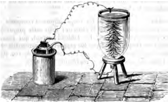
Fig. 344. — Décomposition du chlorure d'étain par la pile voltaïque.
