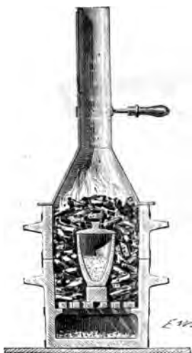
Fig. 338. — Réduction des oxydes des métaux fusibles par le charbon.
