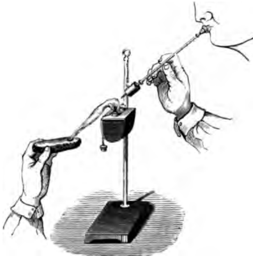
Fig. 655. — Réduction des sels de plomb par le charbon au chalumeau.
