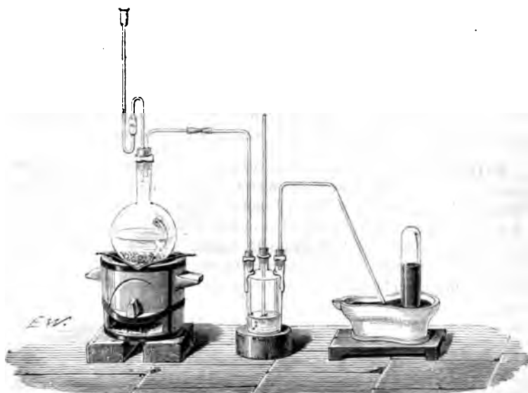
Fig. 634. — Préparation de l'acide sullhydrique par le sulfure d'antimoine.
