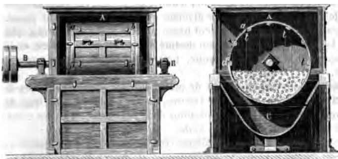
Fig. 479. — Tonne mobile pour la pulvérisation du soufre.
