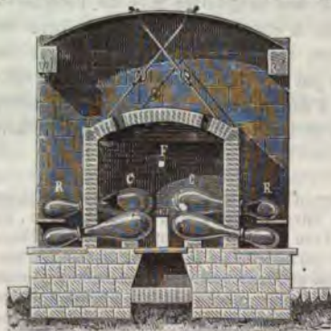
Fig. 671. — Extraction du mercure dans le Palatinat.
