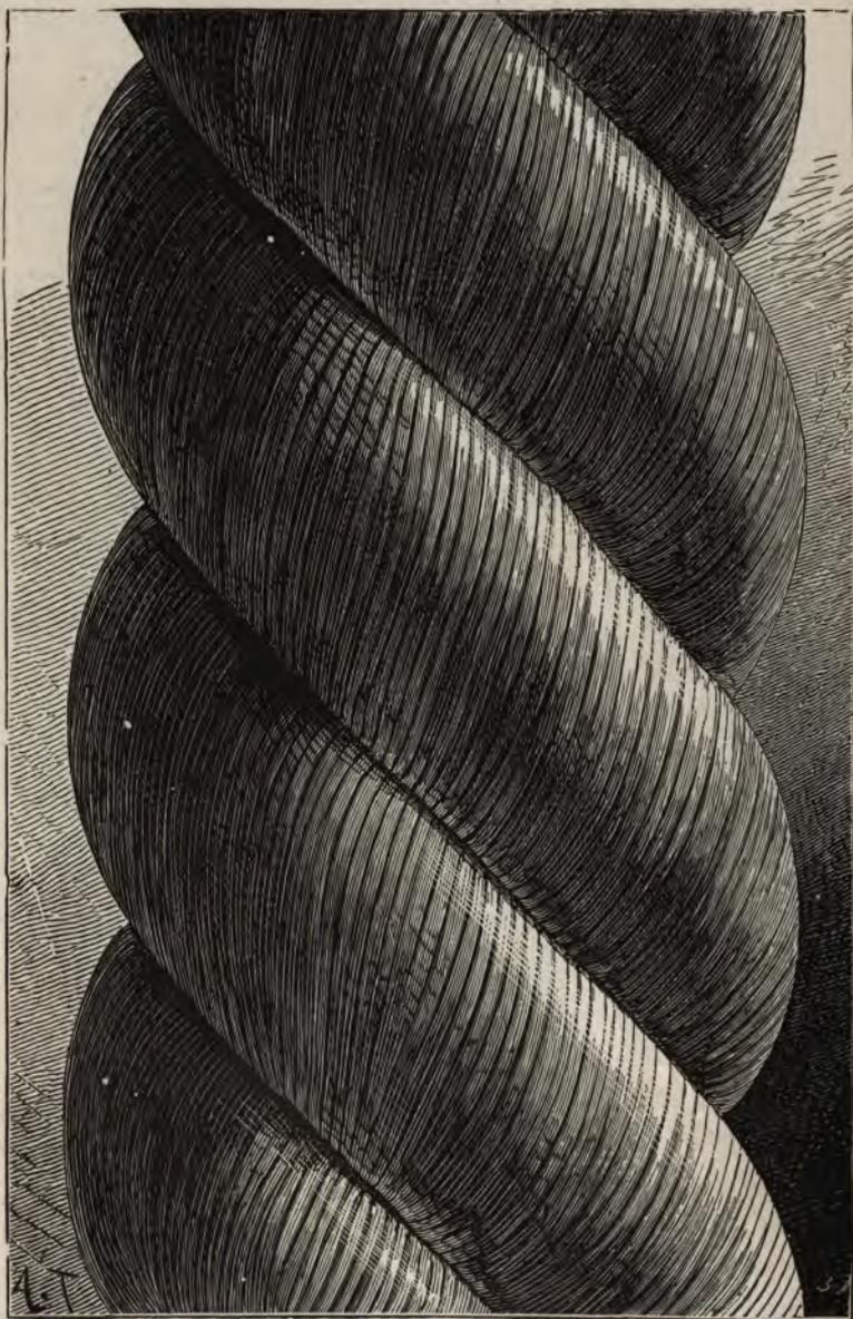
Fig. 12. — Le câble du grand ballon captif. — Aspect en grandeur d'exécution de son extrémité supérieure. (Page 20.)
