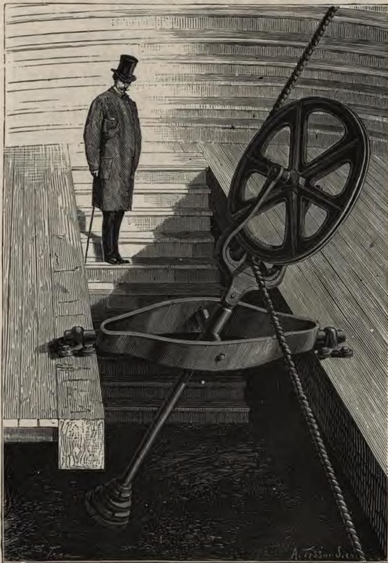
Fig. 15. — Poulie à mouvement universel, où circule le câble du grand ballon captif à vapeur.
