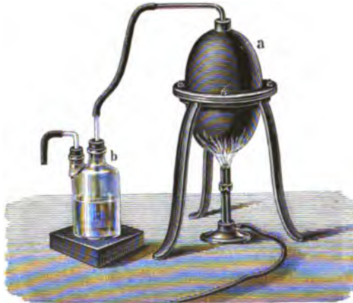
Darstellung von Sauerstoff aus Kaliumchlorat.
