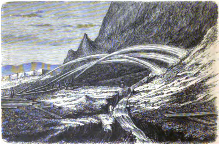
Bearbeitung goldführender Schichten mit starken Wasserstrahlen.
