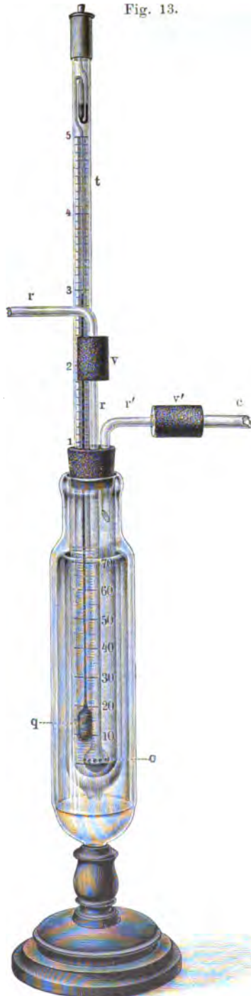
Kalibriertes Vakuumgefäß zur Molekulargewichtsbestimmung nach Erdmann und Unruh.
