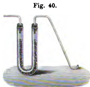
Trockenröhren für \text{CaCl}_2 , \text{CaO} , \text{KOH} und \text{P}_2\text{O}_5 .
