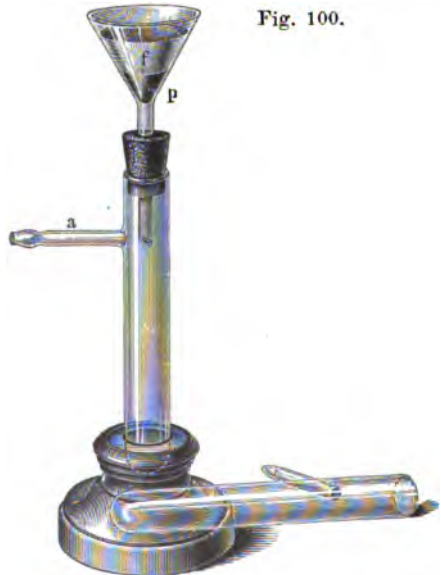
Vorrichtung zum Filtrieren sehr kleiner Flüssigkeitsmengen mit der Saugpumpe (f Papierfilter, p Platinikonus, a Schlauchansatz für die Saugpumpe).
