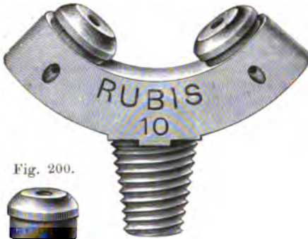
Doppelbrenner für Acetylen in Edelstein gebohrt. (Für einen Gaskonsum von 10 Litern pro Stunde.)
