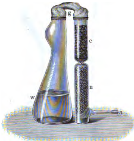
Verfahren von Erdmann und Unruh zur Wertbestimmung von Karbiden.
