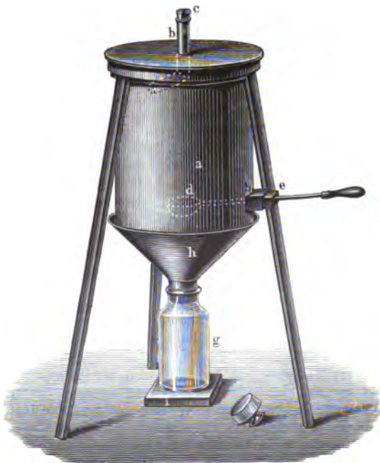
Apparat von Grabowsky zur Darstellung von Phosphorperoxyd.
