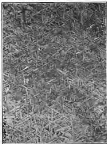
Widmannstätten'sche Figuren auf geschliffenem Meteoreisen.
