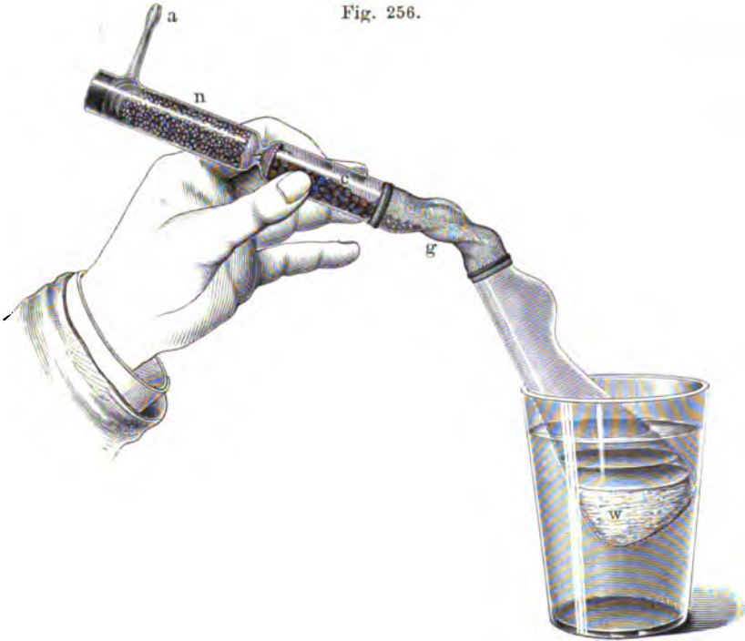
Verfahren von Erdmann und Unruh zur Wertbestimmung von Karbiden.
