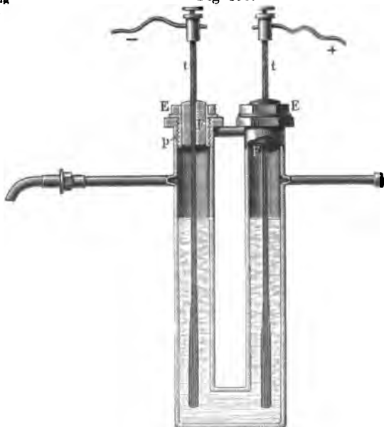
Apparat von Moissan zur Darstellung von Fluor.
