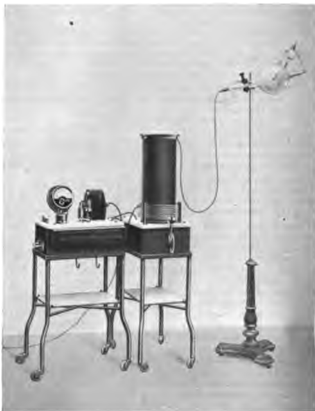
Abb. 26. Anschluß des Instrumentariums für D'Arsonvalisation und Röntgenzwecke an den Siemensschen Diathermieapparat.
