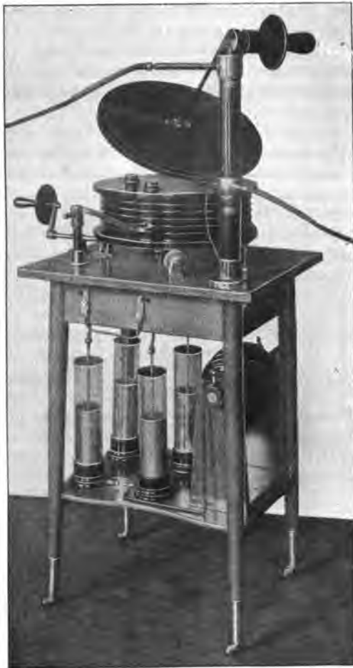
Abb. 16. Sanitas Hochfrequenzapparat für bipolare Applikation mit zwei Paaren von Kondensatoren (Flaschen).
