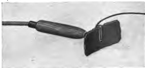
Abb. 63. Hautthermometer zur Verwendung unter einer Plattenelektrode.
