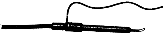
Abb. 65. Chirurgische Metallelektrode, als Thermometer ausgebildet, zur Messung der Temperatur im koagulierten Gewebe.
