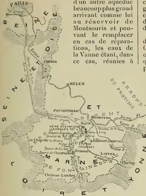
Fig. 6. — Les nouvelles canalisations amenant les eaux du Loingt et du Lunain à Paris.
