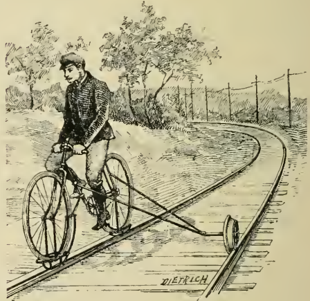
Fig. 6. — Bicyclette disposée pour courir sur les rails d'une voie de chemin de fer.
