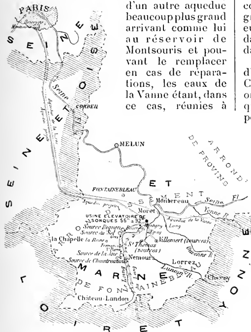
Fig. 6. — Les nouvelles canalisations amenant les eaux du Loing et du Lunain à Paris.
