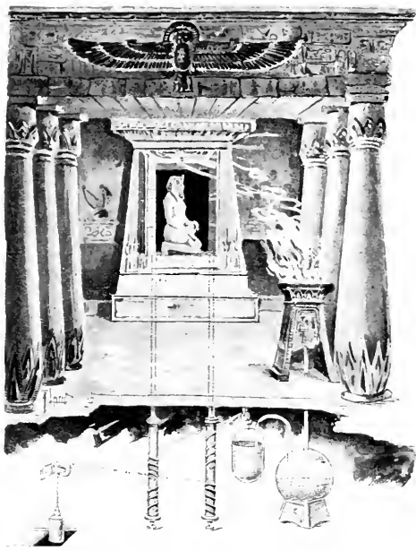
FIG. 1. — APPAREIL POUR OUVRIR ET FERMER AUTOMATIQUÉMENT LES PORTES D'UN SANCTUAIRE
