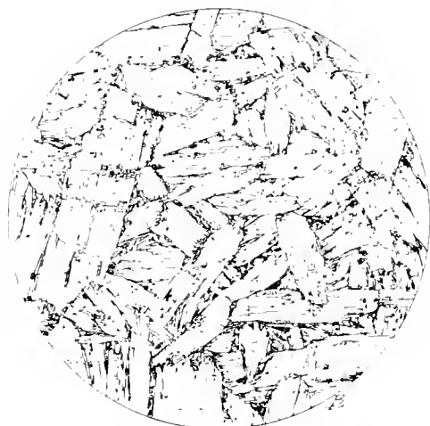
Fig. 1. — Anhydrite accidentelle de la chaudière des Marechaux. Coupe parallèle au dépôt, 60 diamètres.
