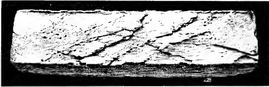
FIG. 1. — Réseau de cassures produit dans une masse de plâtre de 3 centimètres d'épaisseur par la contraction partielle d'une feuille de caoutchouc sous-jacente. 1/2 de la grandeur naturelle.
