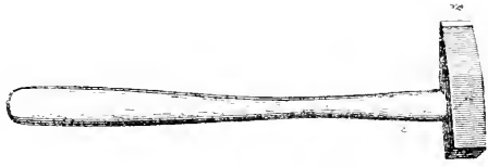
Fig. 2. — Marteau ayant un de ses côtés prolongé en tranchant, ayant l'un des côtés prolongé en tranchant. Son poids est de 500 grammes.
