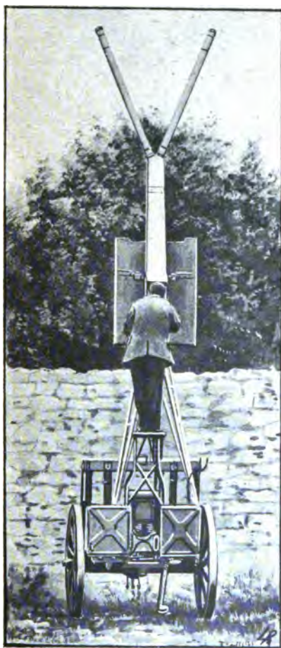
Fig. 31. — Vue d'une lunette-ciseau de batterie allemande.
