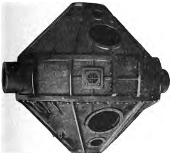
Fig. 183. — Le carter du stabilisateur d'un cuirassé.
