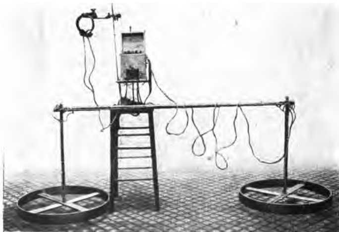
Fig. 145. — Nouvelle balance d'induction construite par le P r Gutton pour rechercher les obus non éclatés dans les champs.
