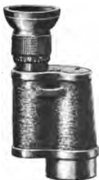
Fig. 27. — Une lunette à prisme monoculaire.
