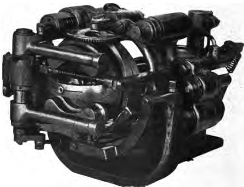
Fig. 173. — Le gyroscope stabilisateur de la torpille.
