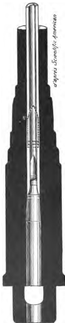
Fig. 121. — Le canon retubé sur une partie de sa longueur réalisant ainsi un nouveau canon à très grande chambre à poudre et à grande longueur en calibres.
