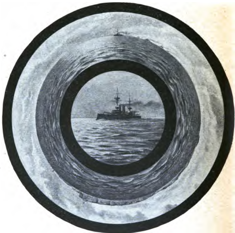
Fig 41. — Ce que l'on voit dans un périscope panoramique. Le tour d'horizon à la partie annulaire; au centre, l'image agrandie d'une portion de l'horizon.
