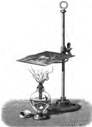
Fig. 8. — Dorure de la plaque daguerrienne.
