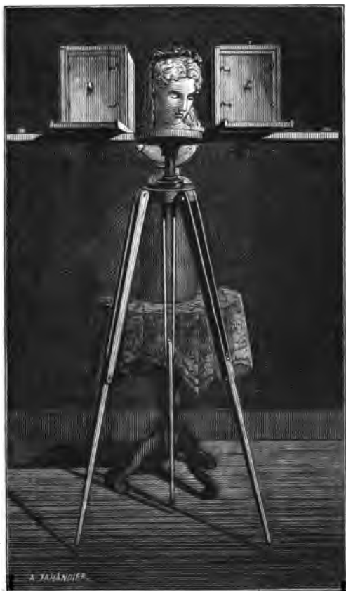
Fig. 61. — Appareil pour l'obtention des deux épreuves photographiques du stéréoscope.
