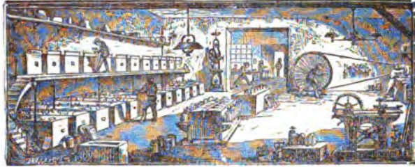
N° 2. — ELECTROTYPIE. — Bains et montage.
