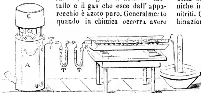
Fig. 1132. — Apparecchio per la preparazione dell'azoto col rame.
