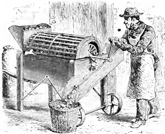
Macchina per lavare i pomi di terra.
