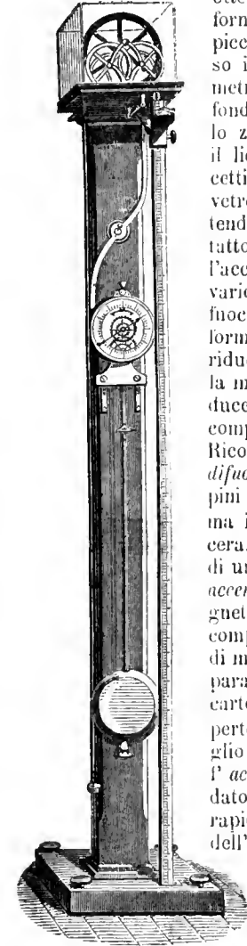
Fig. 78. — Macchina d'Atwood per la prova dell'accelerazione.
