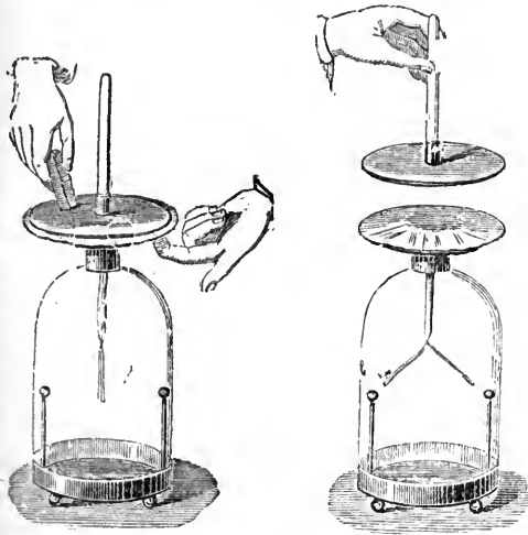
Fig. 2395 e 2396. — Condensatore elettroscopico.
