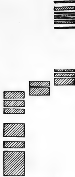
图 5-71 聚甘氨酸能带示意图
