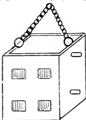
auch im Schacht kein Unglück passieren möge, und die Tonne sich da nicht, wenn der Strick reißt, überschlage, und Zimerung oder Leute beschädigen möge, so ist oben senkrecht über dem untern Stift, noch einer angebracht. Vermöge dieser beiden (oder die 2 auf jeder Seite gezählt dieser 4) Stifte muß die Tonne ohnfehlbar zwischen den 4 Sparren [79] [1 1784
