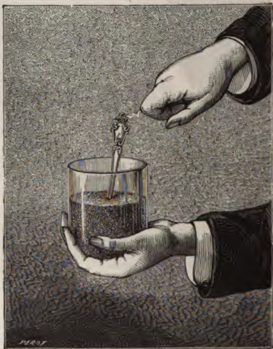
Fig. 144. — Une bouteille de Leyde faite avec un verre, du plomb de chasse et une cuiller.
