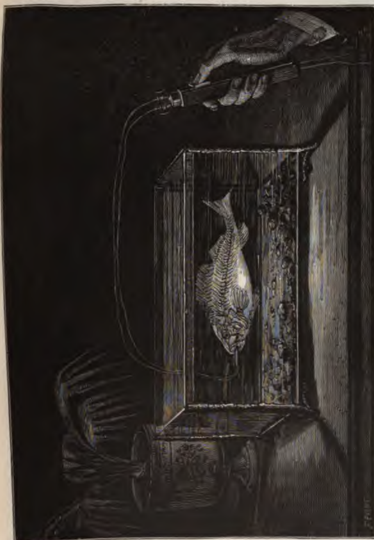
Fig. 147. — Poisson vivant rendu lumineux et transparent au moyen du polyscope électrique.
