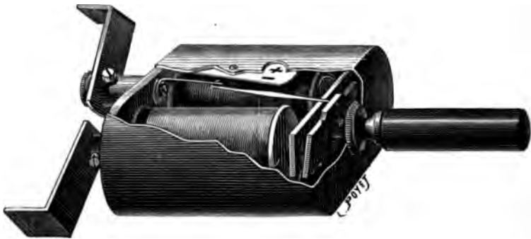
Fig. 93. — Sonnerie d'essai des piles, système Barbier-Picret (grandeur naturelle).
