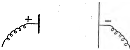
Fig. 12. — Signe conventionnel des piles.
