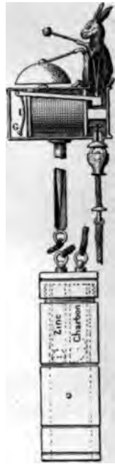
Fig. 132. — Coupe d'un bijou électrique et de la pile qui le met en mouvement.
