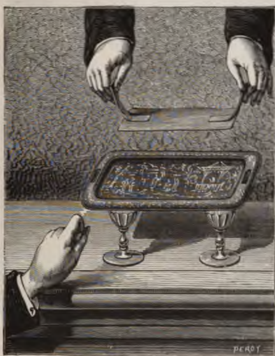
Fig. 143. — Un électrophore confectionné au moyen d'un plateau à thé et d'une feuille de papier.
