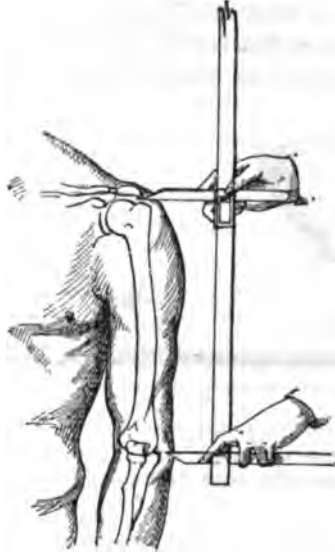
Fig. 219. — Position et façon de se servir de la glissière anthropométrique pour prendre la longueur ou projection verticale du bras.
