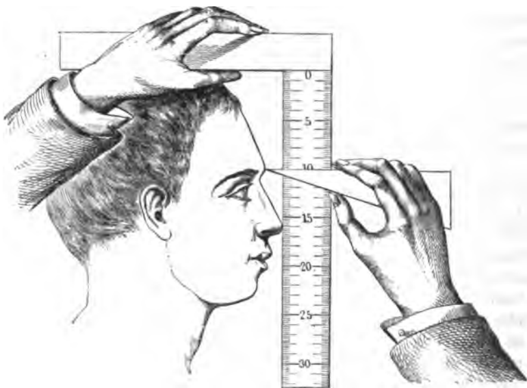
Fig. 197. — Équerre céphalométrique pour prendre les proportions verticales de la tête.
