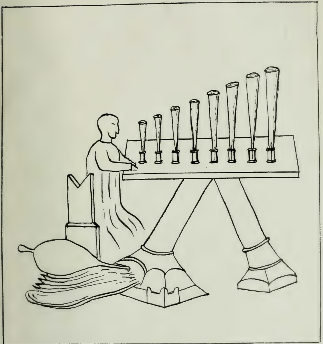
PLANCHE IV. — SCHÉMA D'UN JEU D'ANCHES AUX XI e -XII e SIÈCLES
