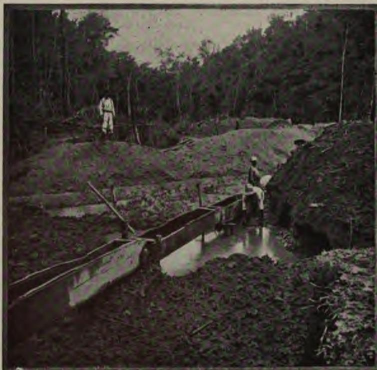
FIG. 178. — Nègre lavant à la batée le long des dalles. (Cliché Gachet, obtenu par le vérascope Richard.)
