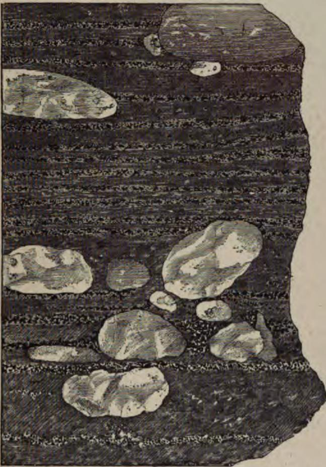
FIG. 107. — Minerai de la Wemmer (South-Reef) au huitième niveau Ouest, montrant une disposition très nettement stratifiée des zones pyriteuses représentées en noir et des galets de quartz (figurée en blanc), dans un ciment siliceux. — Grandeur nature. (Cliché de M. de Launay.)
