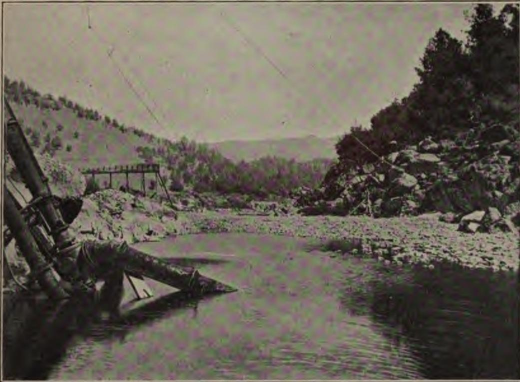
FIG. 99. — Appareil de suction pour élévateur hydraulique en Californie. (La gravure montre le remous de l'eau qui se précipite vers l'orifice du tuyau.)
