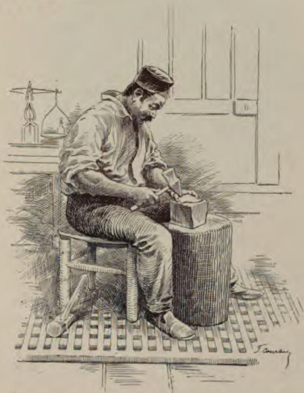
FIG. 250. — Le fondeur-forgeur martelant une bande de lingot laminé avant le battage.
