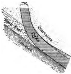
FIG. 18. — Coupe d'un dyke (d'après de Launay, *Mines d'or du Transvaal*, p. 276).
