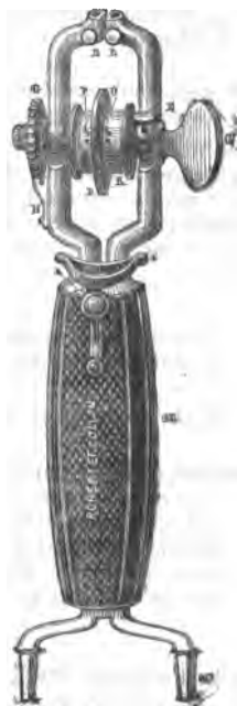
Fig. 1. — M, manche du sécateur. — I, interrupteur. — O, lame d'ivoire graduée.
