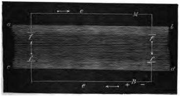
a b en c d zijn de oevers van de rivier; B de galvanische batterij; M de electromagnetische toestel; e e zijn de telegraafdraden, loopende evenwijdig met den oever der rivier en eindigende in dezelve met de koperen platen f f. Het is nu duidelijk dat de stroom, door de batterij opgewekt, door de rivier gaat links en na op den electromagneet te hebben gewerkt, regts terugkeert. De proef is al-
