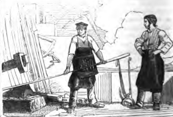
Fabrication du petit fer au martinet.
