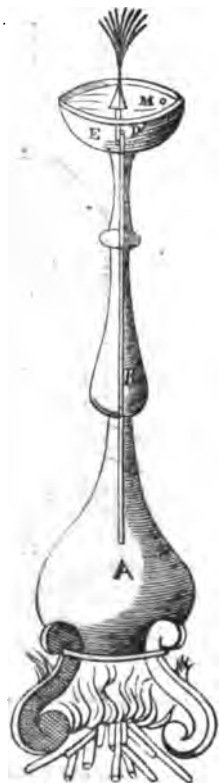
Fig. 10. Machine à élever de l'eau du P. Kircher. (Fac-similé.)
