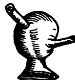
Fig. 5. Éolipyle à double tube, de Cardan.
