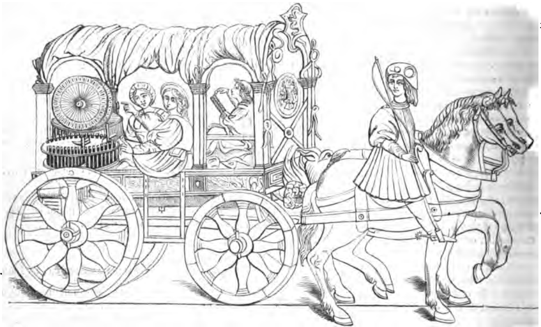
Fig. 1. Odomètre de Vitruve, d'après une gravure sur bois de l'édition donnée par Cisarino en 1521.
