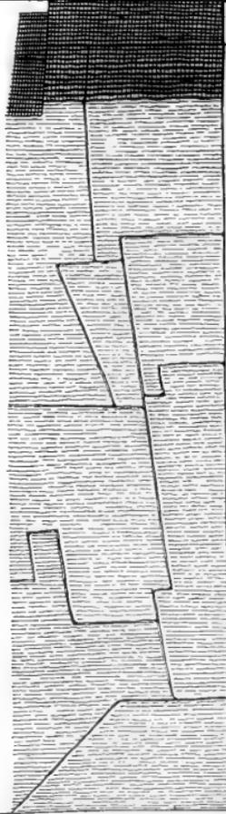
*Fig. 3.* Construction des grandes enceintes de beaucoup de villes antiques de la Grèce, dont la citadelle est en construction cyclopéenne. Cet appareil à joints latéraux inclinés sert de fondement à une construction en pierres parallélogrammes rectangles dans les murs de Cortona, quand au contraire elle a elle-même pour fondement la construction cyclopéenne dans les murs de Cefalû en Sicile. Houel, *Voyag. en Sicile*, T. I. c. 9. pl. 49 et 51.
