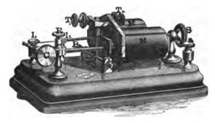
FIG. 55.—TELEGRAPHIC RELAY.
