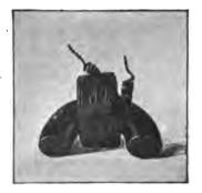
FIG. 51.—AERO-FERRIC MAGNETIC CIRCUIT.
