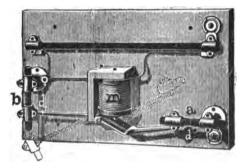
FIG. 65.-ELECTROMAGNETIC LIGHTNING ARRESTER.
