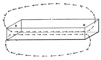
FIG. 14.-SIMPLE MAGNETIC CIRCUIT.
