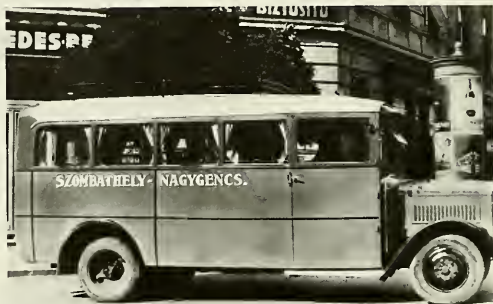
102. Mávag—Mercedes-Benz alvázra épített, 30 személyes autóbusz. 1932
