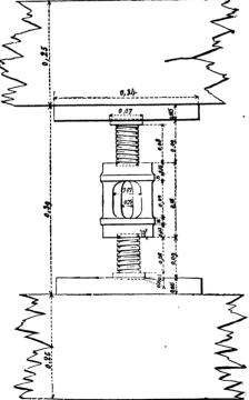
cylindre est donc au plus de 25 kilogrammes par centimètre carré ou de 25 atmosphères; sur la section méridienne, la pression, pour un mètre de hauteur serait de 30×100×25 ou de 75,000 kilogrammes; cette tension est supportée par la double section verticale de la fonte, c'est donc 37,500 kilogrammes par section, et, pour que la tension ne dépasse pas un kilogramme par millimètre carré, il faudra donner comme épaisseur à la fonte 0m,0375.
