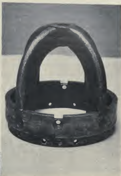
FIG. 48. — Couronne de fer pour ouverture de coffres-forts. Les dents en acier manquent.
