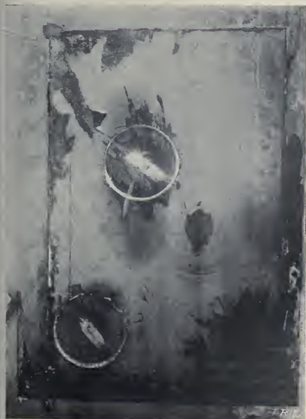
FIG. 49. — Traces sur le blindage d'un coffre produites avec l'instrument de la figure 48.
