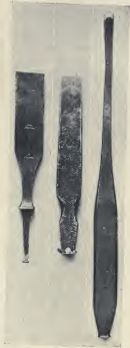
FIG. 34. — Outils dont se sont servis Courtois et son complice. De droite à gauche : tamponnoir, ciseau de serrurier, ciseau de menuisier.
