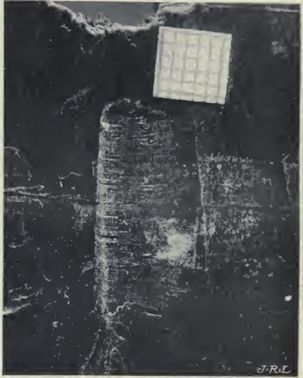
FIG. 38. — Stries du tranchant de l'instrument d'effraction sur un meuble à bois verni.
