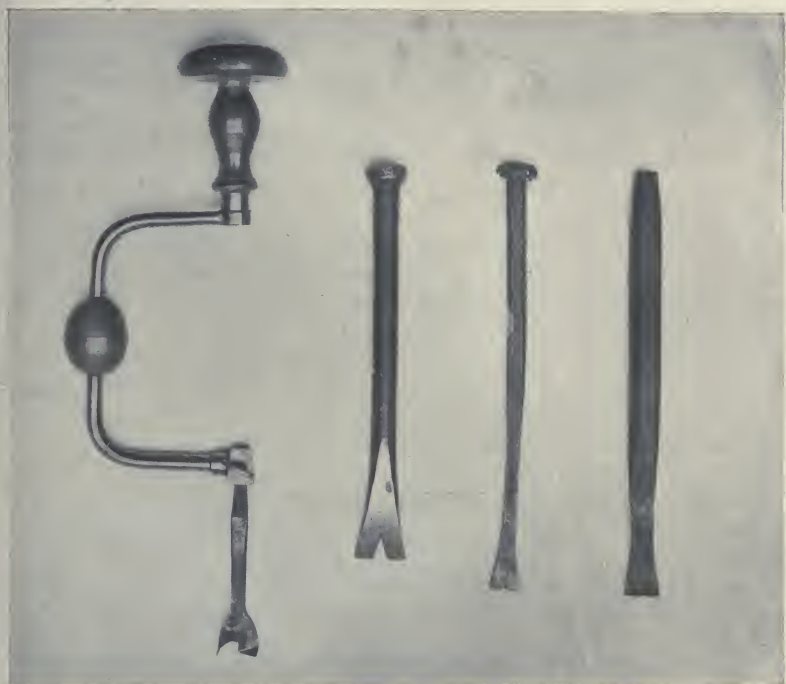
FIG. 22. — Vilebrequin, pied de biche, dents de tailleur de pierre.
