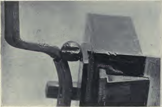
FIG. 60. — La serrure avec les traces d'effraction.
