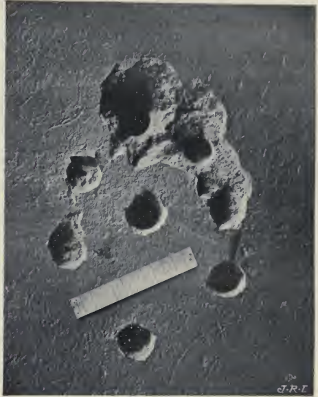
Fig. 51. — Essai de percement d'un mur depuis le corridor.
