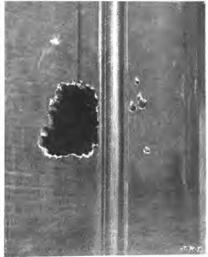
FIG. 26. — Détail de la figure 25 : on voit nettement les trous du foret pour rechercher la targette.
