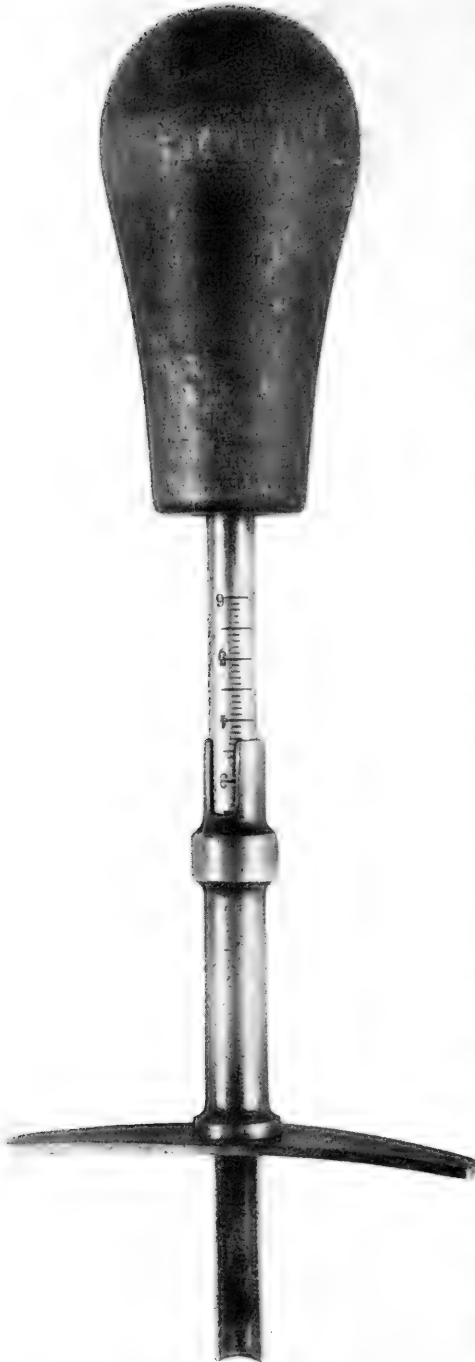
Fig. 3. Skogsforsöksanstaltens barkmått. — Instrument for bark measurements.
