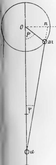
Soit  $r$  le rayon de la roue de transmission montée sur l'arbre de la manivelle, et  $r_1$  le rayon de la roue qui engrène avec la précédente, et qui est montée sur l'axe latéral, nous aurons pareillement
