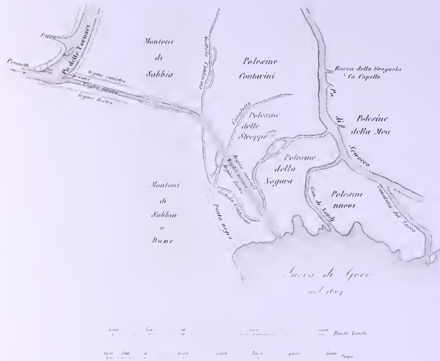
Mappa del nuovo taglio del Po sottoquando fu aperto con pennelle e spioni stati aggiunti alla sua bocca (Zandroni - memorie an. VII e VIII)
