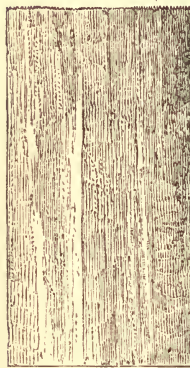
FIG. 17.—Fibrous structure of best Bar Iron.
