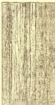
FIG. 18.—Structure of inferior Bar Iron.
