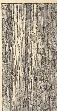
FIG. 18.—Structure of inferior Bar Iron.
