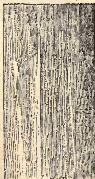
FIG. 17.—Fibrous structure of best Bar Iron.
