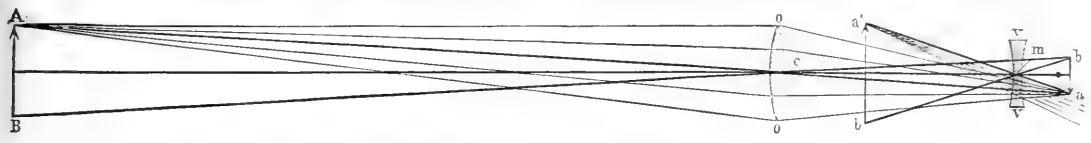
Fig. 2. Wirkung des Galileischen Fernrohrs.
