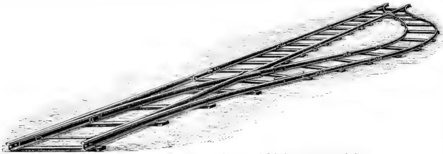
Fig. 6. Ausweichung mit Rechts- und Linkszungenweichen.
