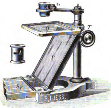
Fig. 298. Fuesssche Lupe für polarisiertes Licht.
