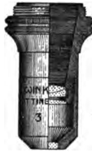
Fig. 812. Winkelsches Achromat 3 f = 12 mm U = 0,35 "
