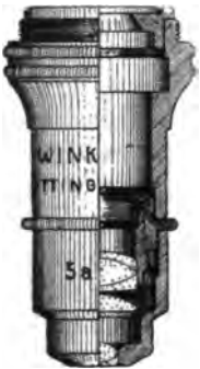
Fig. 813. Winkelsches Achromat 5 a f = 5,6 mm U = 0,75 "
