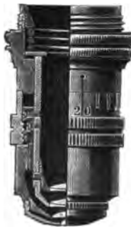
Fig. 819. Zeiss'sches Apochromat mit Korrekionsfassung f = 3 mm U = 0,95 "
