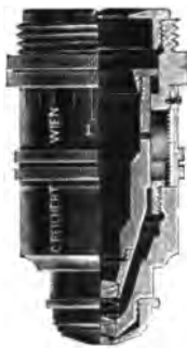
Fig. 818. Reichert'sches Apochromat mit Korrekionsfassung f = 4 mm U = 0,95 " Stellung für dünnes Deckglas
