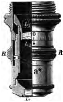
Fig. 810. Zeiss'sches Achromat a* mit Korrekionsfassung f = 48 - 29 mm U = 0,10 "
