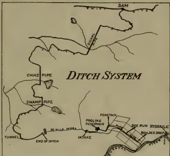
DITCH SYSTEM, QUESNELLE HYDRAULIC G. M. CO.
